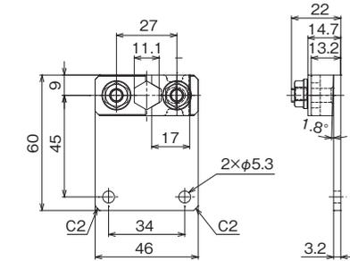
十字穴付六角アセットボルトM5×14 (SW組込み) M5ナット
