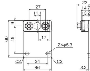
十字穴付六角アセットボルトM5×14 (SW組込み) M5ナット
