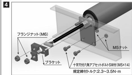
1. ベース金具をリード線側シャフトに取付け十字穴付アセットボルト(M5)でフレームに固定してください。
