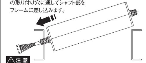
3 反リード線側のシャフトをスライドさせてもう一方のコンベヤフレームに差し込みます。スプリングの力によって戻るので、パルスローラSENERGYの着脱はコンベヤフレームを分解する必要はありません。
