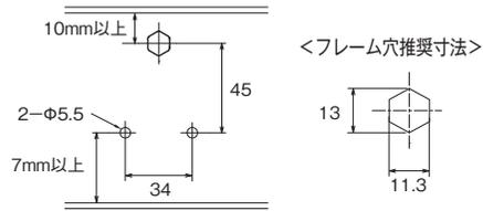
2 パルスローラSENERGYのコネクタ付リード線をフレームの取り付け穴に通してシャフト部をフレームに差し込みます。
