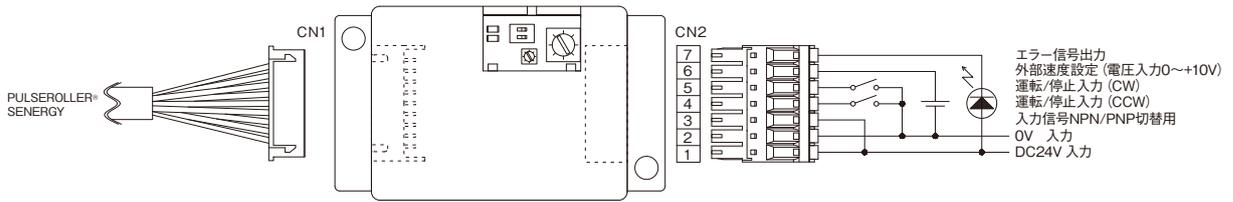
※ドライバーカードに接続する電源は、「PULSEROLLER<sup>®</sup>専用」となります。
