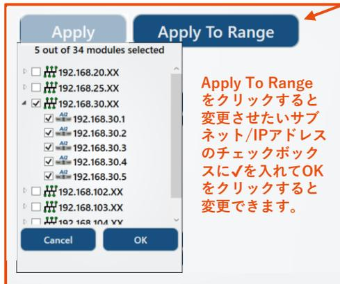
Apply To Range をクリックすると変更させたいサブネット/IPアドレスのチェックボックスに✓を入れてOKをクリックすると変更できます。
