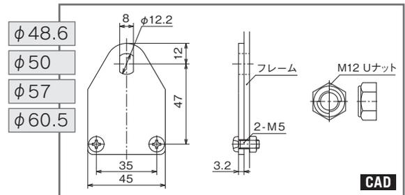
Uナット締め付けトルク：目安34.1N・m
