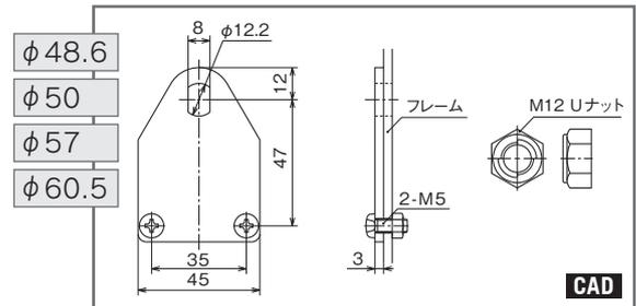
Uナット締め付けトルク:目安34.1N・m
